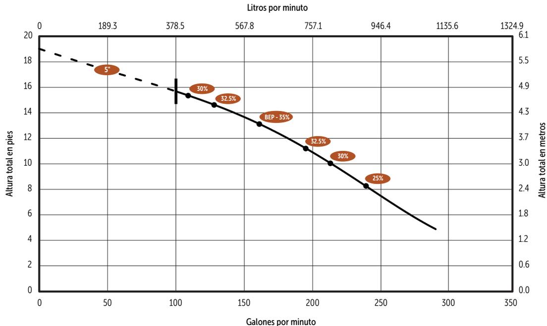
\*Las eficiencias indicadas son eficiencia hidráulica.
